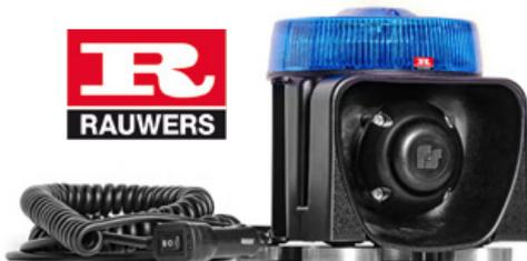
System besteht aus Solaris-LED-Leuchte LP400 und Kompaktsirene SC1000. Befestigung durch 6 Magnete mit Schutzbeschichtung auf dem Fahrzeugdach. Anschluss mittels Spiralkabel an den Zigarettenanzünder, Bedienknopf mit den Funktionen Blaulicht / AUS / Blaulicht und Sirene. 15 Hochleistungs-LEDs, parabolischer Reflektor erhöht die Helligkeit und verhindert Schattenbereiche. Sirene: Leistung 30 W.
