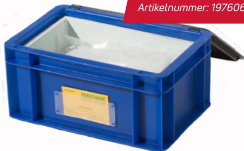
Zum Löschen von Bränden von kleinzelligen Akkus oder zur sicheren Aufbewahrung der Akkus. Gesamtsystem bauart- und funktionsgeprüft durch Materialprüfanstalt ZSW Ulm. Löschgranulat auf Basis von geblähtem Glas zur Neutralisierung von Fluorwasserstoffdämpfen (HF-Dämpfen). Behälter aus PE mit Scharnierdeckel, Durchführung für Ladekabel Ø 13 mm, integrierte Brandschutzwanne. Geeignet für die Brandklassen A und D.
