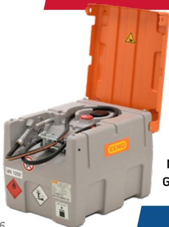
Zum Transport und für den unmittelbaren Verbrauch von Dieseldieselkraftstoff. Füllstutzen mit integrierter Be- und Entlüftung, Handkolbenpumpe 0,25 l/Hub, Entnahmeleitung 2,7 m mit Absperrhahn und Zapfventil. Einwandiger Behälter mit Klappdeckel, Stapleraufnahme, Vertiefungen für Zurrgurte, Schlauchhalterung, Halter für Zapfpistole, Tragegriffe.
