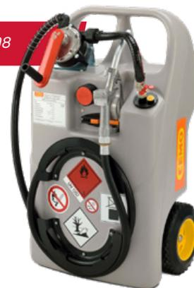
Zum Transport und für den unmittelbaren Verbrauch von Dieseldieselkraftstoff. Füllstutzen mit integrierter Be- und Entlüftung, Handkurbelpumpe 0,38 l/Umdrehung, Entnahmeleitung 3,0 m mit Absperrhahn und Zapfventil. Rad-Ø 240 mm, Halter für Zapfpistole, integrierter Handgriff, Tragegriffe.
